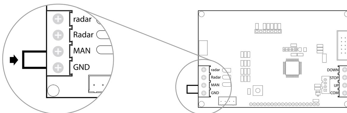
**ATIVAR FECHO AUTOMÁTICO:** Remover shunt **GND - MAN** na placa da tampa.
